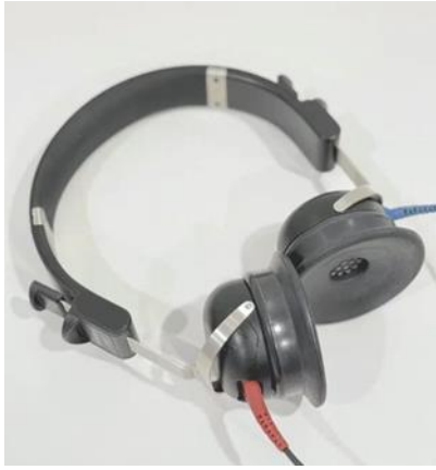
Рисунок 1. Головной телефон (амбушюры накладного типа).
